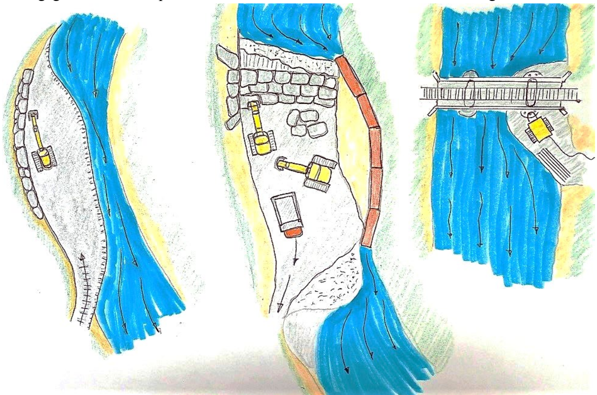
Figura 10 (L. De Antonis): A sinistra, messa in secca parziale per costruzione difesa spondale; in centro, messa in secca totale per realizzazione scala di risalita; a destra messa in secca parziale per consolidamento pile di un ponte.
