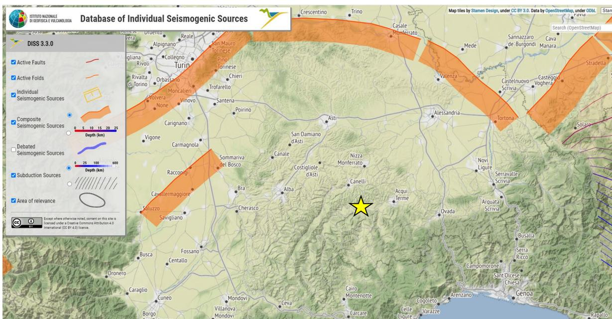
Figura 11 – Estratto del DISS, zone sismogenetiche e ITHACA, faglie capaci (l'asterisco giallo indica il sito in oggetto)
