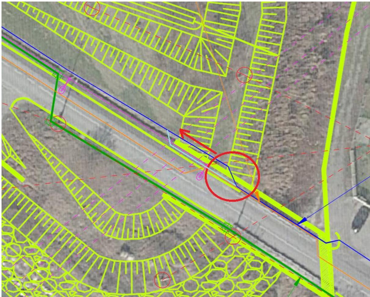
*Figura 4.2: Risoluzione interferenza acquedotto – diaframma
