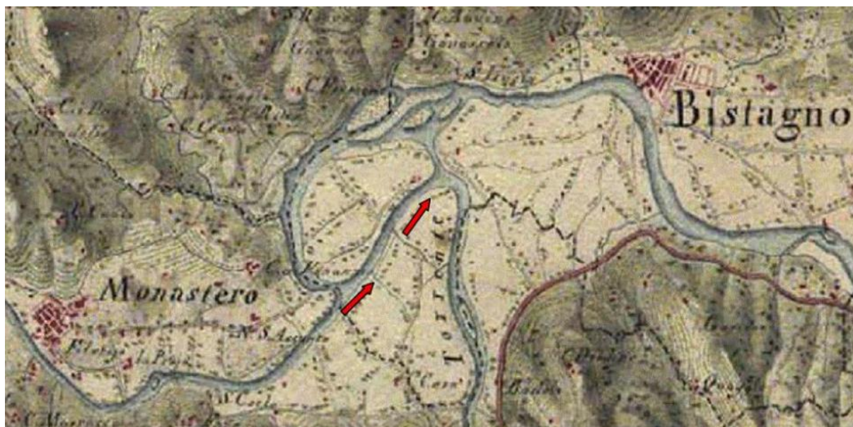
Figura 4.7: Durante l'evento le acque di piena hanno occupato il vecchio canale (indicato dalle frecce) che si collegava al Bormida di Spigno (Fonte: arpapiemonte.it)
